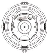
La mousse absorbant les chocs contenue dans le PPSC aide à prévenir les dommages au dewar. L'illustration montre la vue de dessus du réservoir dans le PPSC.
