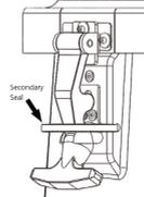
La conception du loquet en caoutchouc permet l'utilisation d'un serre-câble, d'un sceau vétérinaire, d'un sceau de sécurité, etc. pour garantir l'intégrité du produit expédié.
