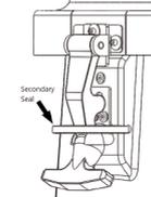
Die Gummiverriegelungskonstruktion ermöglicht die Verwendung eines Kabelbinders, Sicherheitssiegels usw., damit das Produkt unversehrt transportiert werden kann.
