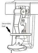
O fecho de borracha permite o uso de uma braçadeira plástica, lacre de segurança, etc. para assegurar a integridade do produto transportado.
