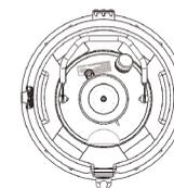
La schiuma ammortizzante in PPSC aiuta a impedire i danni al dewar. L'illustrazione mostra una vista dall'alto del serbatoio in PPSC.
