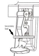
Il design della chiusura in gomma consente l'uso di una fascetta metallica, tenuta a umido, tenuta di sicurezza, ecc. per assicurare l'integrità del prodotto spedito.
